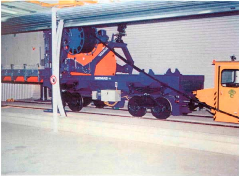
Demonstrationsanlage zur sicheren Einlagerung von Pollux-Behältern im UPP II in Peine.
