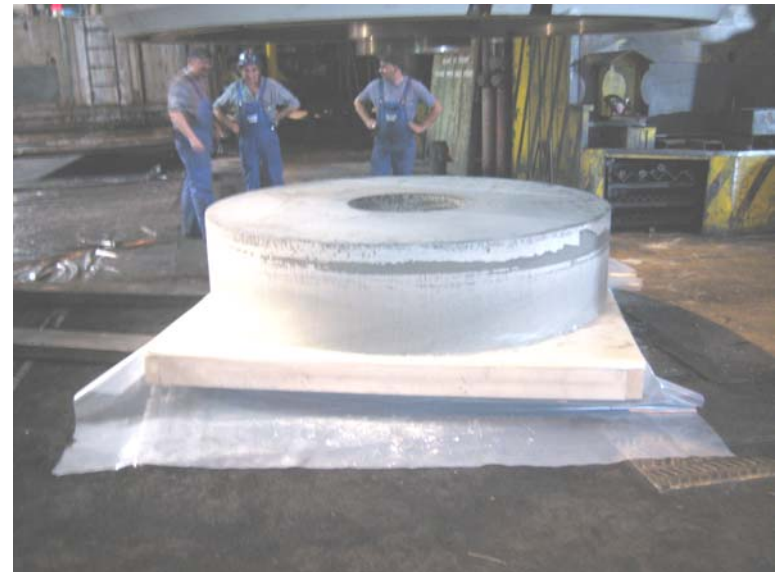
Un anneau de bentonite compactée après démoulage
