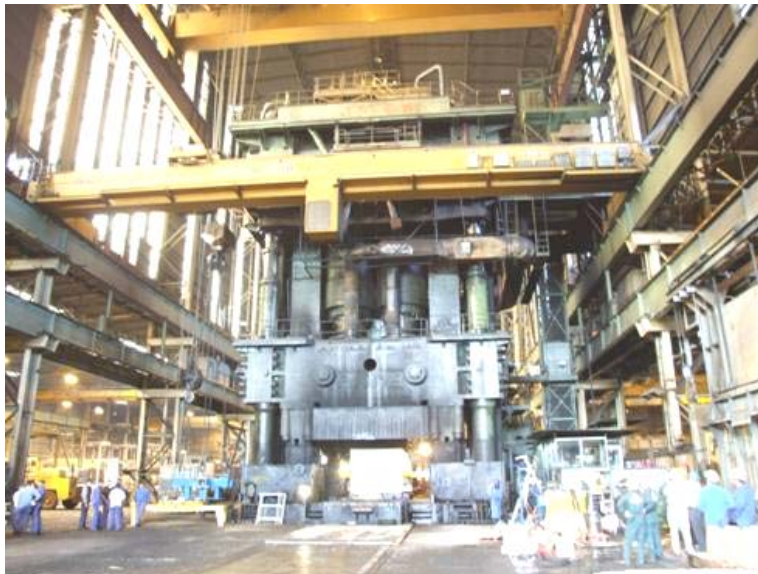
Le moule sous la presse de capacité 65 000 tonnes à Issoire
